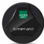
Une solution simple de suivi des températures en environnement fixe ou mobile, avec récupération des données par radio.
